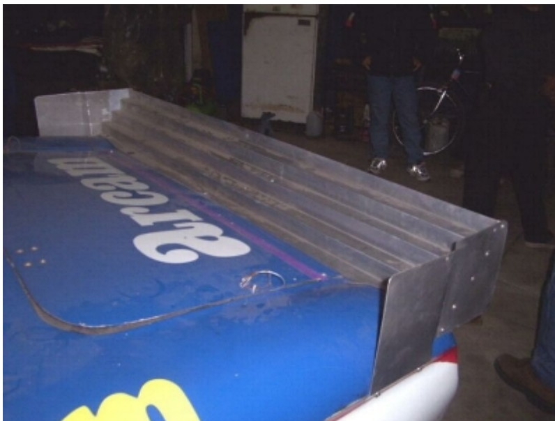
El alerón construido por Sugar para el Ford de TC4000 de Luis Gebhard
